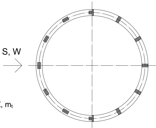
Dimenzionisanje prstena: složeno savijanje – M, Z, m<sub>t</sub>
